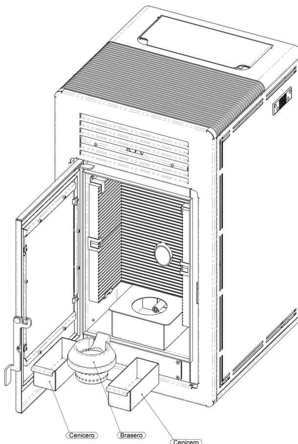
1. Retire el brasero y elimine los restos no quemados que hayan podido quedar depositados sobre él.
