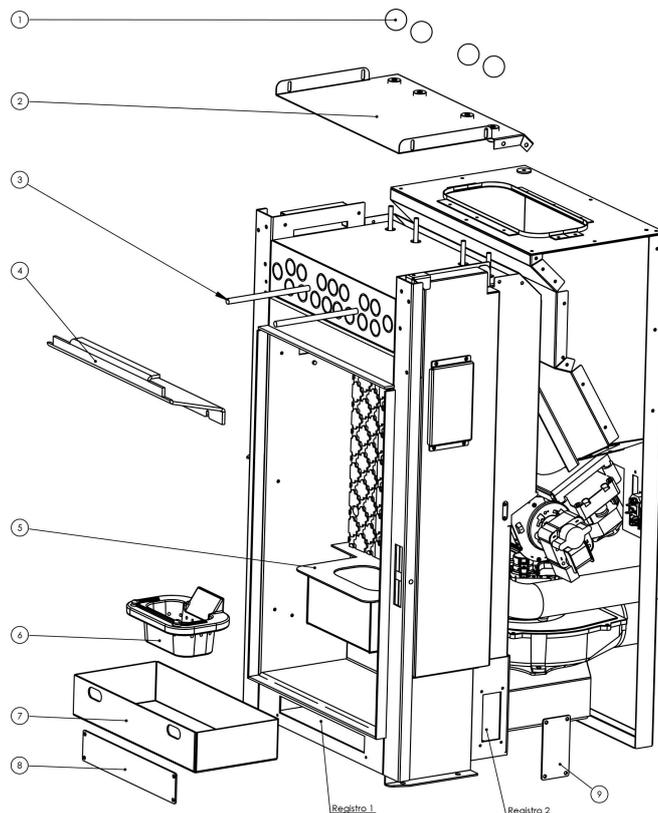
2. **Desconecte la estufa.** Abra los paneles laterales de la estufa, registro 3, 4, y 5 mediante las tapas que están atornilladas. Limpie cuidadosamente el serrín y el polvo de los tubos de aire comburente y aire de combustión.
