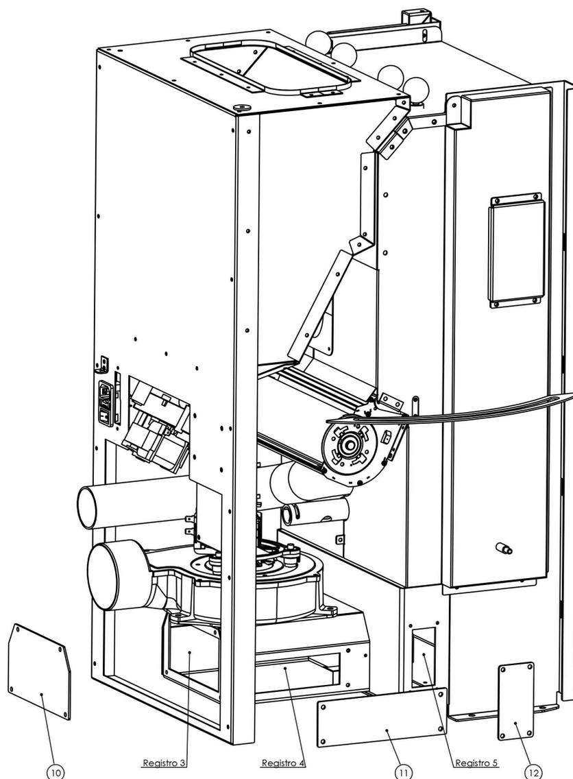
3. Cuidadosamente limpie alrededor de los ventiladores. Si los cables eléctricos se desconectan llame a su distribuidor para su reparación.
