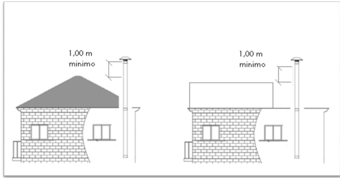
Fig. 1 Altura correcta terminales de chimenea con cubierta en pendiente y plana
