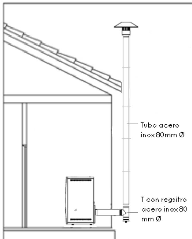
Instalación Vertical: Salida de Humos Exterior: tubo interior.
