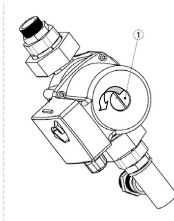
Esta operación consiste en girar en el sentido de la flecha y con la herramienta adecuada el tornillo(1) hasta quitarlo. Así facilitamos la salida del aire de la instalación.
