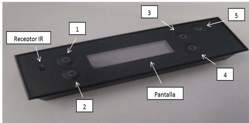
1. **Botón On/Off**: Apretando este botón durante unos segundos se acciona la función de encendido o apagado.
